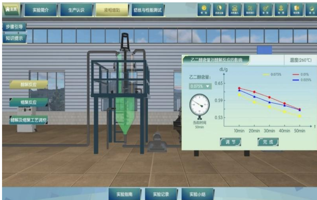
图 19：乙二醇含量对醇解反应的影响
